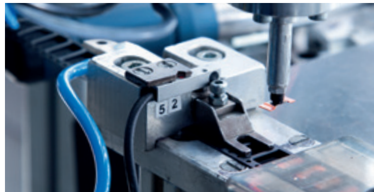
Vor der Verpackung in Standardgurte werden die Bauelemente umfangreich getestet, gemessen und abgeglichen
